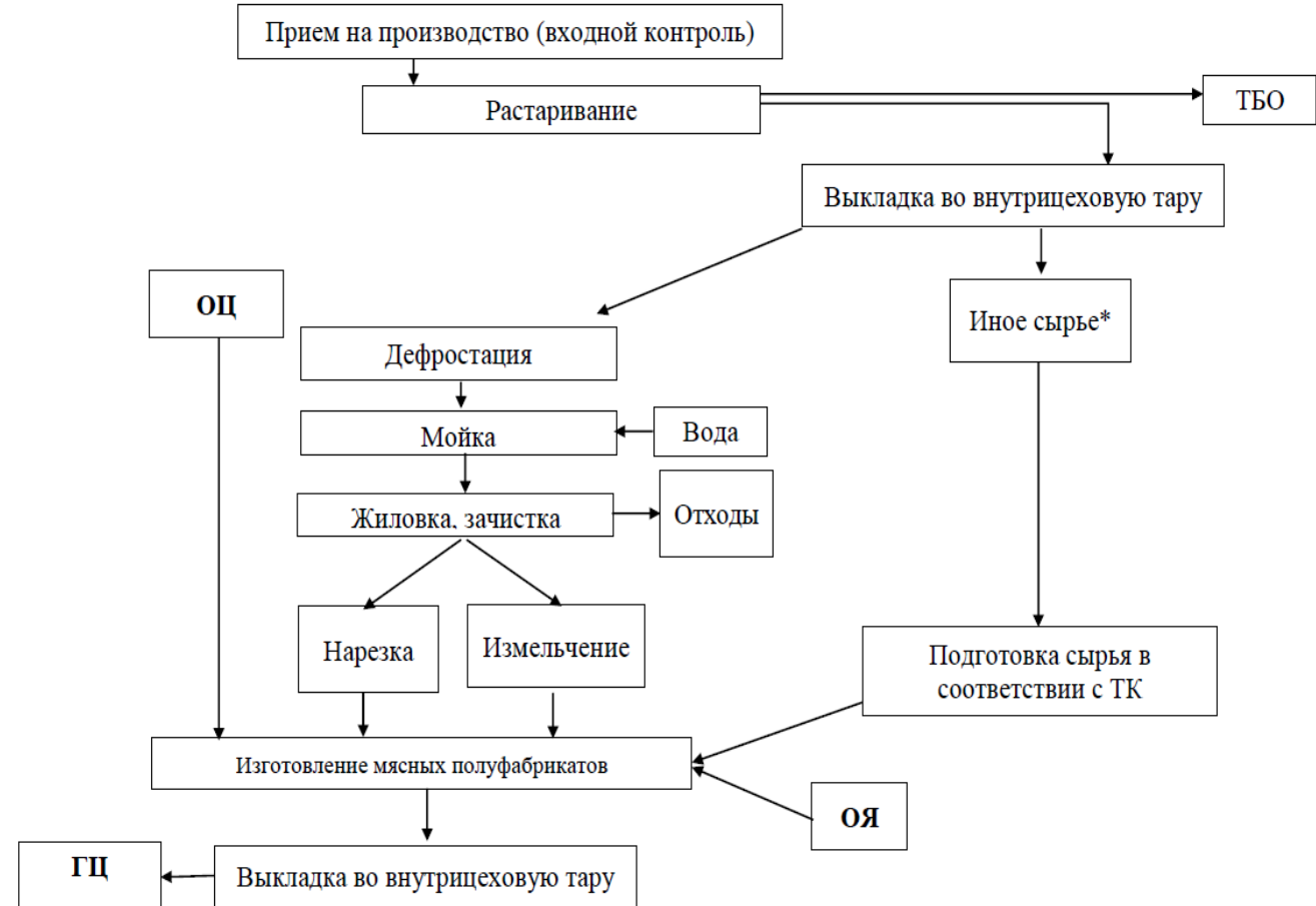
Блок-схема производства мясных полуфабрикатов (МРЦ пищеблока)
